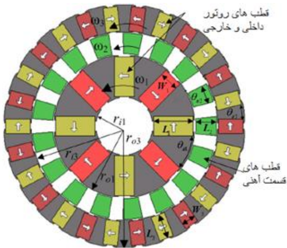
شکل (۳): گیربکس مغناطیسی نمونه جهت تحلیل روابط [۱۴]
