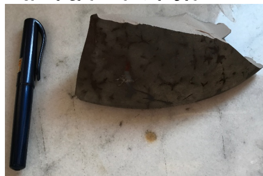
ب) قسمت رویی نمونه بعد از شست‌وشوی مرحله اول شکل (۵): نمونه‌ی مقره شسته شده با آب مقطر در حمام فراصوتی
