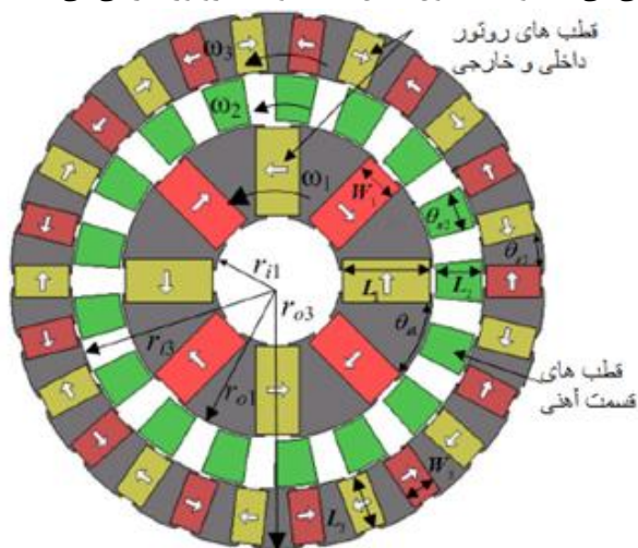
شکل (۳): گیربکس مغناطیسی نمونه جهت تحلیل روابط [۱۴]
