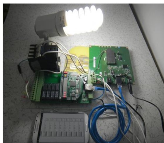
شکل (۸): کنترل مصرف‌کننده ۲۲۰ ولت با موبایل اندرویدی
