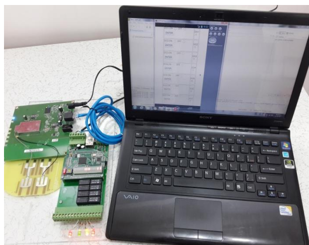
شکل (۷): کنترل LEDهای ۲۴ ولت DC با شبیه‌ساز نرم‌افزار Eclipse
