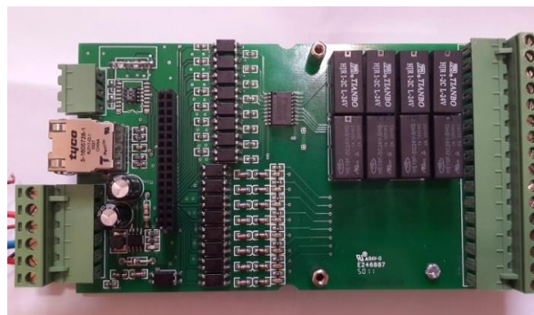
شکل (۲): برد رله شامل ورودی‌ها و خروجی‌های دیجیتال
