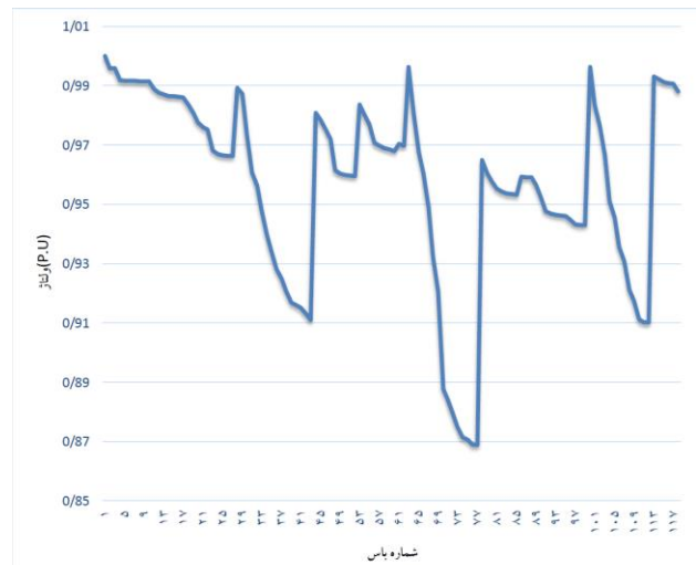
شکل (۴): پروفیل ولتاژ شبکه توزیع پایه
