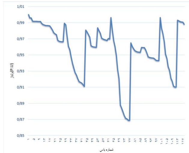
شکل (۴): پروفیل ولتاژ شبکه توزیع پایه
