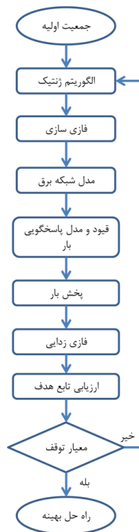
شکل (۱): فلوچارت چارچوب پیشنهادی برای بهینه‌سازی عملکرد شبکه توزیع با در نظر گرفتن پاسخگویی به تقاضا، منابع انرژی تجدیدپذیر، باتری، خودروهای الکتریکی، OLTC و تنظیم‌کننده‌های ولتاژ با استفاده از الگوریتم فازی-ژنتیک
