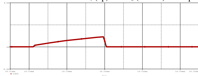
شکل (۱۱): شکل موج شبیه سازی شده جریان دیود D_o مبدل پیشنهادی (4A/div, 1 \mu s) Figure (11): The simulated current of D_o in the proposed converter
