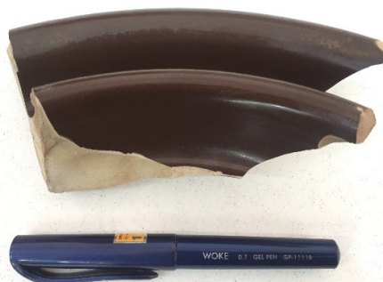
شکل (۸): نمونه‌ی مقره پس از شست‌وشو با محلول پایه و مکمل
