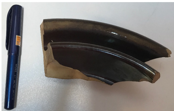
شکل (۶): نمونه‌ی مقره پس از شست‌وشو با محلول پایه
