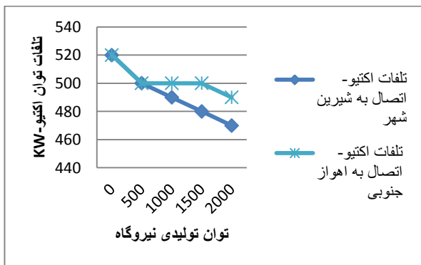
شکل (۸): روند تغییرات تلفات توان اکتیو شبکه به ازای تولیدهای مختلف نیروگاه
