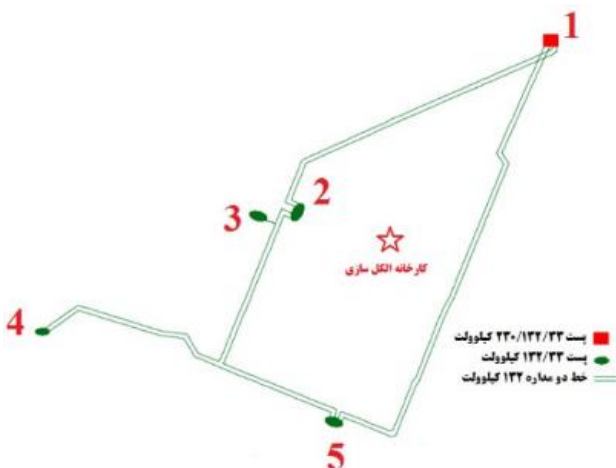
شکل ۳: شبکه برق محل کارخانه الکل سازی
