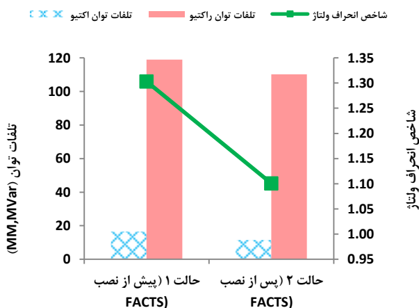
شکل ۱۱: تاثیر نصب ادوات FACTS بر تلفات و شاخص انحراف ولتاژ شبکه ۵۷ شینه
