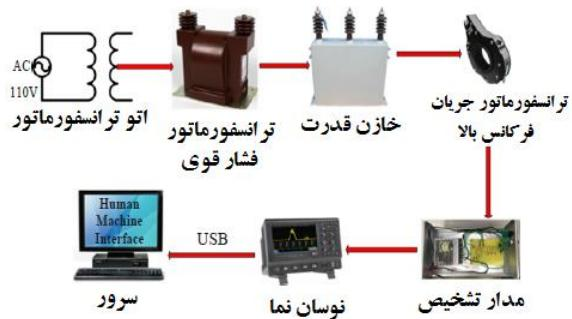
شکل ۳: پلت فرم آزمایشگاهی اندازه‌گیری تخلیه جزئی
