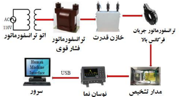
شکل ۳: پلت فرم آزمایشگاهی اندازه‌گیری تخلیه جزئی
