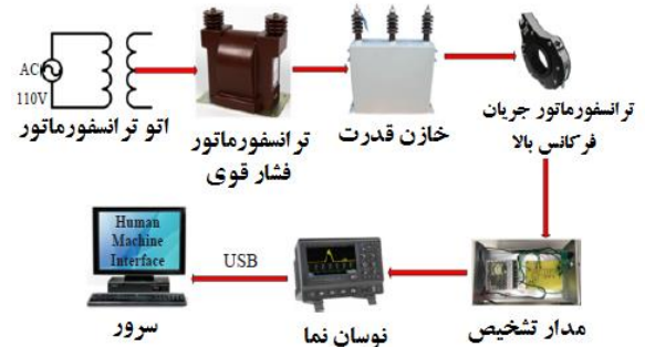
شکل ۳: پلت فرم آزمایشگاهی اندازه گیری تخلیه جزئی
