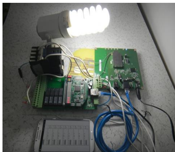
شکل (۸): کنترل مصرف کننده ۲۲۰ ولت با موبایل اندرویدی
