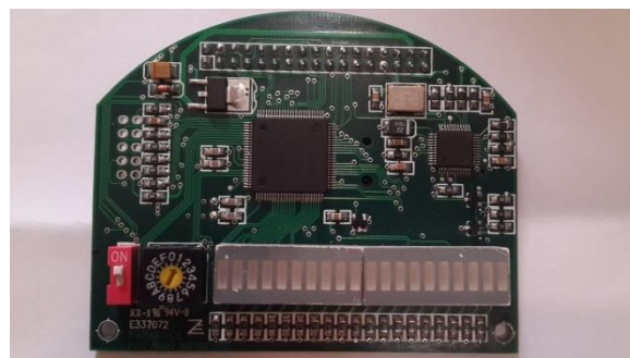
شکل (۱): برد اصلی شامل پردازنده ARM
