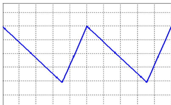
شکل (۶): شکل موج جریان L_1 . ولتاژ/div 0.1V، زمان 2μs/div
