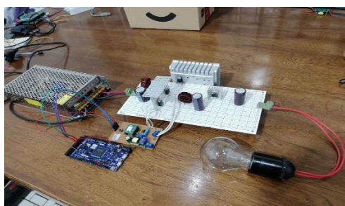
شکل (۱۷): مدار آزمایشگاهی برای مبدل‌های DC/DC
