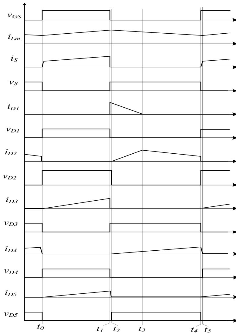
شکل (۳): شکل موج‌های کلیدی ولتاژ و جریان مبدل پیشنهادی
