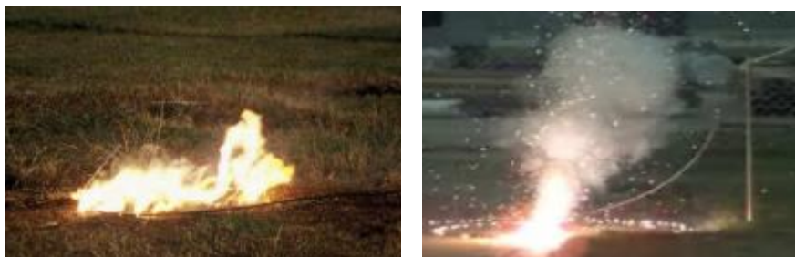
شکل (۲): نمونه هایی از خطای امپدانس بالا بر روی سطح بتن و چمن [۱۳، ۱۴]
