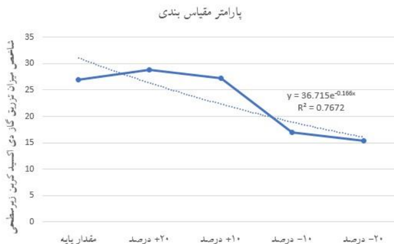
شکل (۴): تأثیر پارامتر مقیاس بندی بر کنترل تزریق گاز و دبی تولیدی میدان
