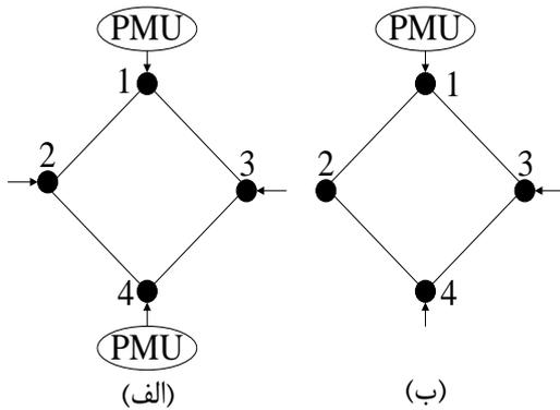
شکل (۵) - مکان‌یابی بهینه PMU برای یک سیستم ۴ شینه (الف) و (ب) شین تزریق صفر نادیده گرفته شده است
