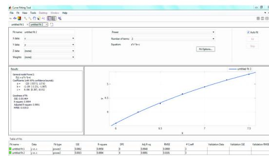
شکل (۴) استفاده از جعبه‌ی ابزار Cure Fitting جهت به دست آوردن تابعی برای نمودار تولید سالیانه‌ی توربین وستاس ۲ مگاواتی در ارتفاع ۸۰ متری بر حسب میانگین سرعت سالیانه‌ی باد
