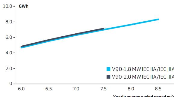
شکل (۳) تولید سالیانه‌ی توربین وستاس ۲ مگاواتی در ارتفاع ۸۰ متری بر حسب میانگین سرعت سالیانه‌ی باد
